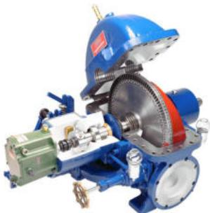
Nuestra turbina de tamaño más popular es la SB18, diseñada principalmente como motor para bombas. El conjunto de rotor con rodamientos de bolas ha demostrado ser un enfoque rentable para fabricar una turbina sencilla. La ventaja del conjunto con rodamientos de bolas es la prolongación de la vida útil de los rodamientos. Estas unidades son perfectas para aplicaciones que no requieren cumplir con los estándares API-611.
