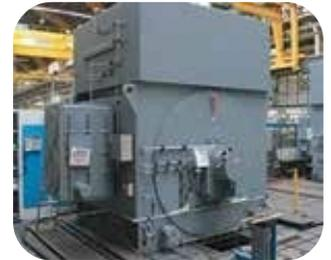
Motor síncrono de baja velocidad de 12 MW, 30 polos, utilizado en el proyecto LDPE de Qilu Petrochemical.
