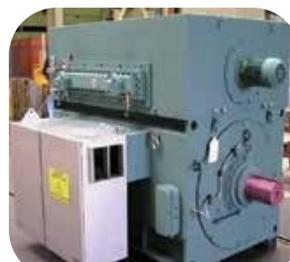
Motor de 1655 kW, 690 V, utilizado en un proyecto de plataforma petrolera móvil para accionar una bomba de ventilación.
