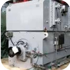
Motor asíncrono de alta tensión (HV) de presión positiva de 7750 kW, 10 kV, 2 polos, utilizado en el proyecto de gas natural licuado Huasheng Energy para accionar un compresor centrífugo.
