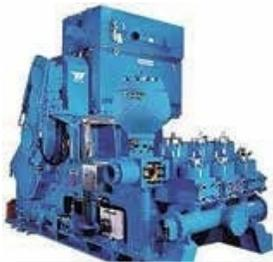
Bomba de lodo de 1655 kW, 690 V utilizada en el proyecto de plataforma de perforación de Wirth Maschinen-und Bohrgeräte.
