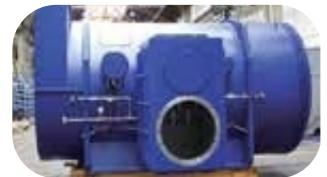
Motor de bomba de petróleo de 3300 kW, 6000 V utilizado en el proyecto Janaf Pipeline-Ruhr-pumpen GmbH.
