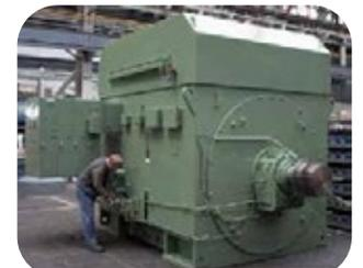
Motor de 9,300 kW, 11 kV, utilizado para accionar el granulador de extrusión en el proyecto Kobelco, Japón-AD-NOC, EAU.
