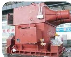
Motor EXP de tipo de presión positiva de 6,500 kW, 11 kV, utilizado en la refinería Iran Abbas.
