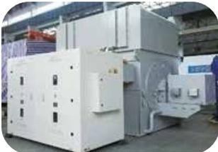
Generador de turbina de gas de 32 MW, 10.5 kV, 1500 rpm, 4 polos con excitación sin escobillas, utilizado en el proyecto Siemens Matching Katie.
